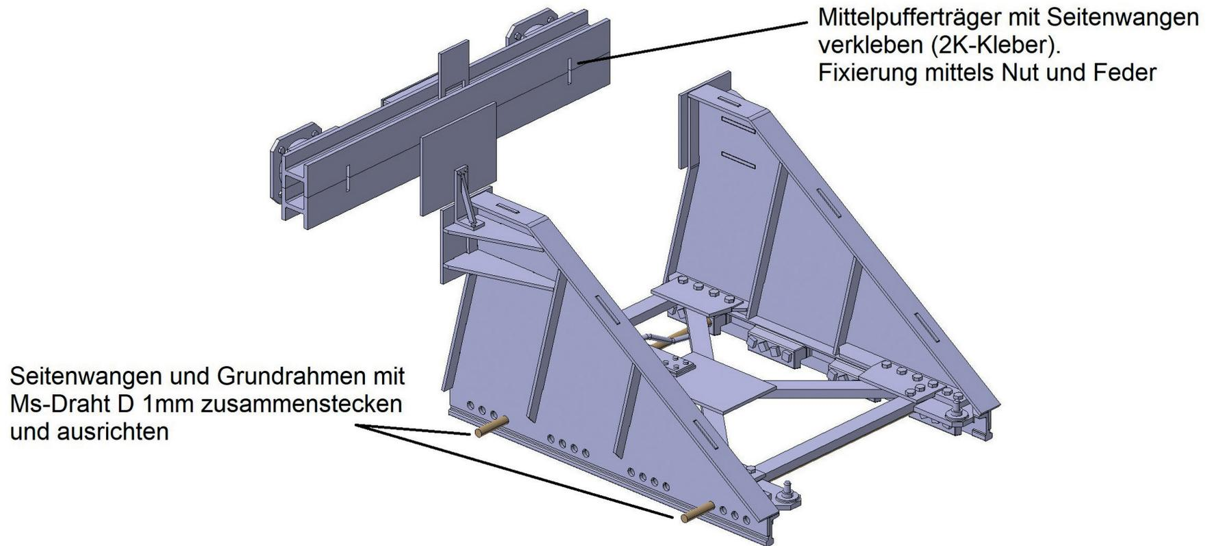
Nachdem der Mittelpufferträger befestigt ist kann der Grundrahmen eingeklebt werden. Dazu die beiden Ms-Drähte herausziehen, den Grundrahmen mit 2K-Kleber bestreichen und zwischen die Rahmenwangen vorsichtig einschieben. Danach die Drähte wieder durchstecken damit die korrekte Position gewährleistet ist.
