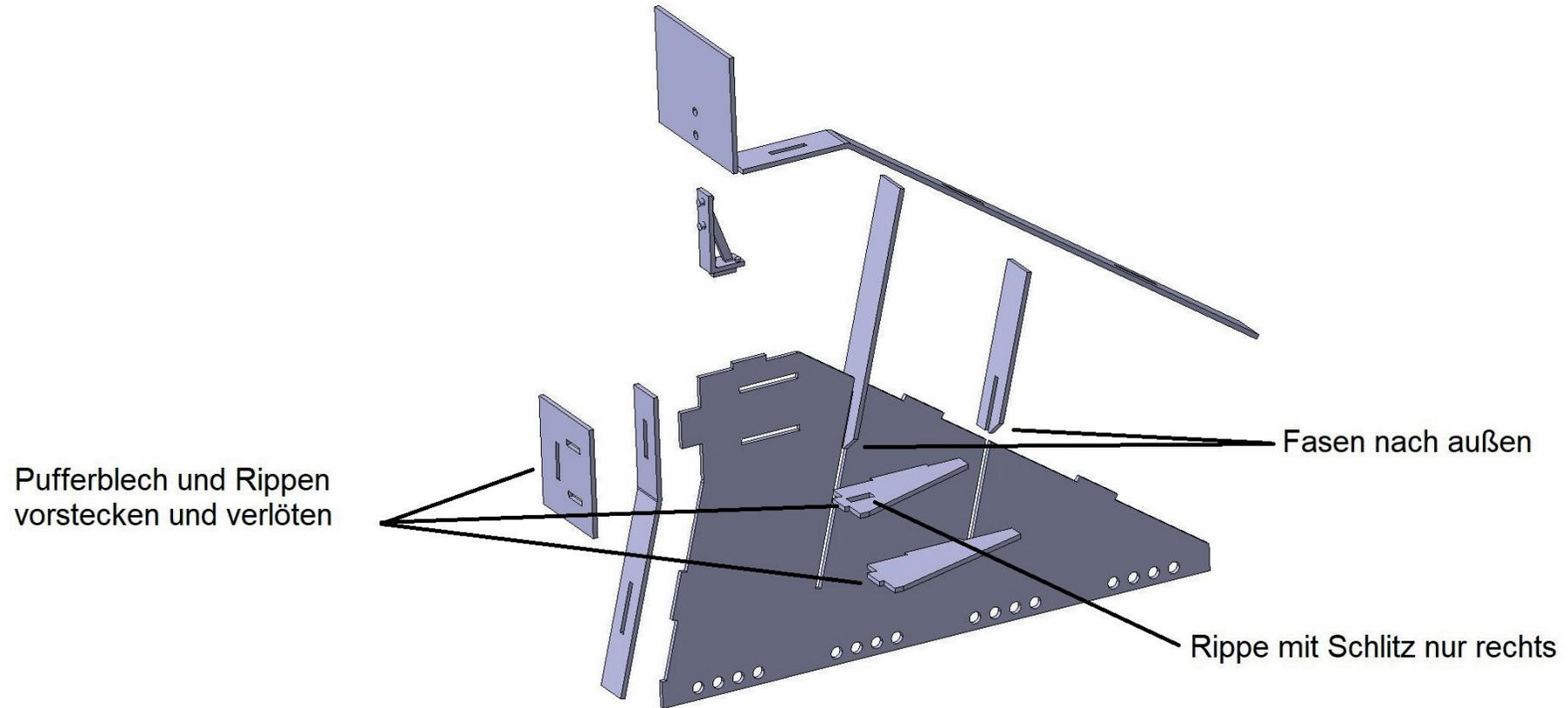
Seitenwange links wie Seitenwange rechts montieren.
